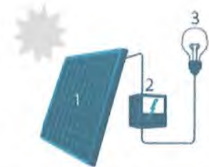
1. Zonnepaneel | 2. Omvormer | 3. Elektrische toestellen
